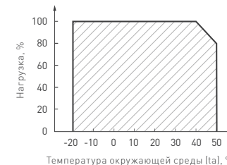
Рисунок 3. Максимальная допустимая нагрузка, % от мощности источника
