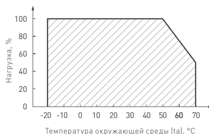
Рис. 2. Максимальная допустимая нагрузка, % от мощности источника
