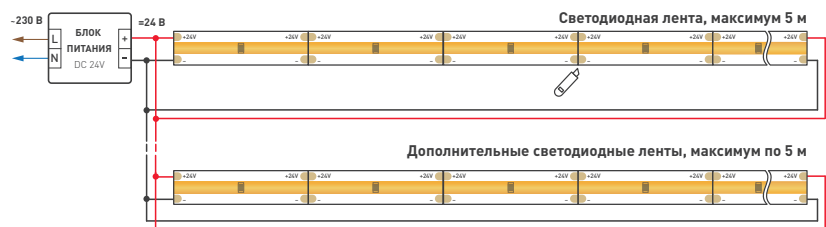
Схема 1. Подключение нескольких светодиодных лент с двух сторон. Рекомендуется использовать для обеспечения равномерного свечения ленты по всей длине
