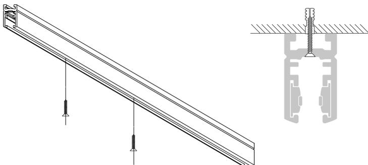
Рис. 5. Установка и подключение трека накладным способом
