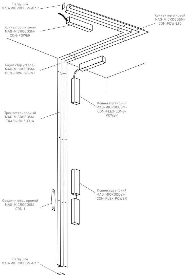
Рис. 2. Элементы и принцип построения разветвленной системы [встраиваемый монтаж]
