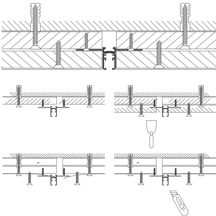
Рис. 4. Установка и подключение трека встраиваемым способом
